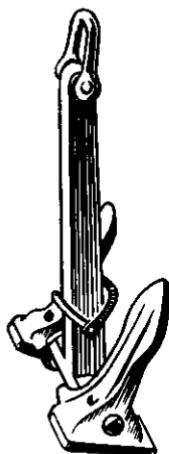
Рис. 12. Якорь с поворотными лапами и отлитыми заодно веретеном и удлиненным трендом
