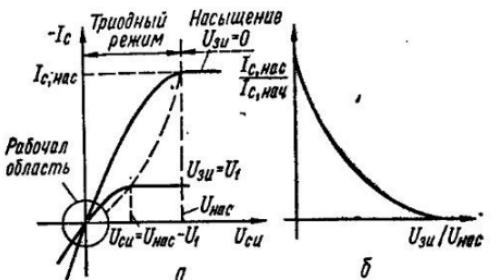
Рис. 2.12. Выходная (а) и входная (б) характеристики полевого транзистора с управляющим  $p-n$ -переходом
