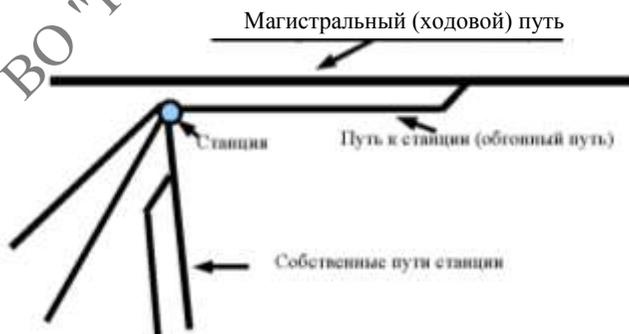
Рис. 6.4. Схема железнодорожной станции с собственным путевым хозяйством
