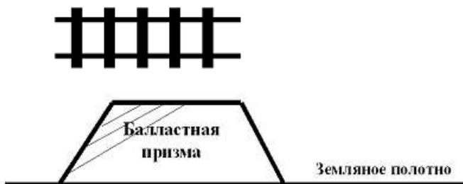
Рис. 6.1. Схематичное изображение рельсошпальной решетки, балластной призмы и земляного полотна
