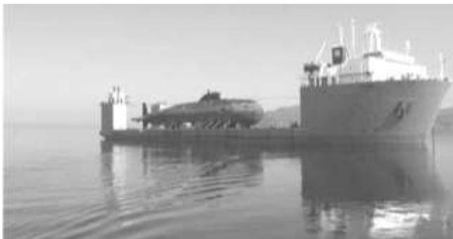
Рис. 4.10. Судно Ro-Flow
