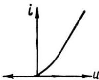
Рис. 166. Вольтамперная характеристика нелинейного элемента
