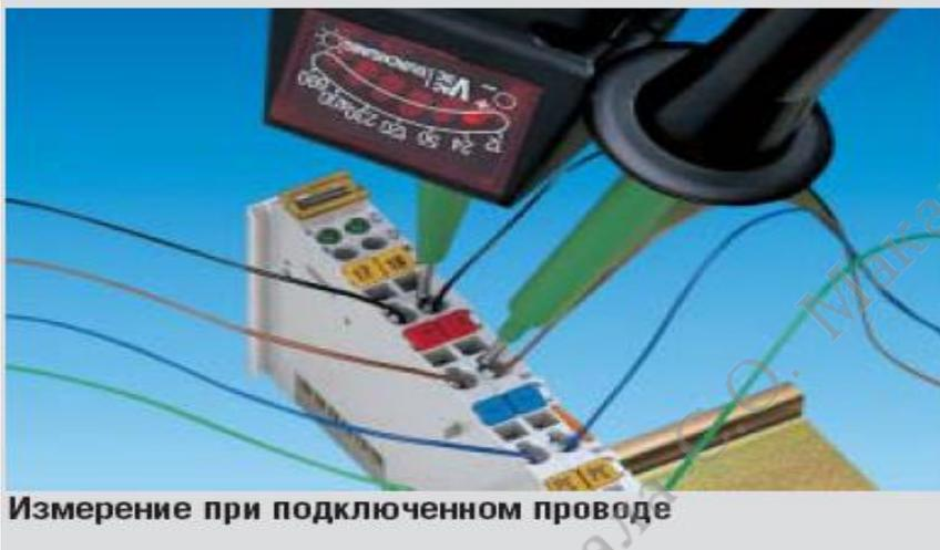
Измерение при подключенном проводе
