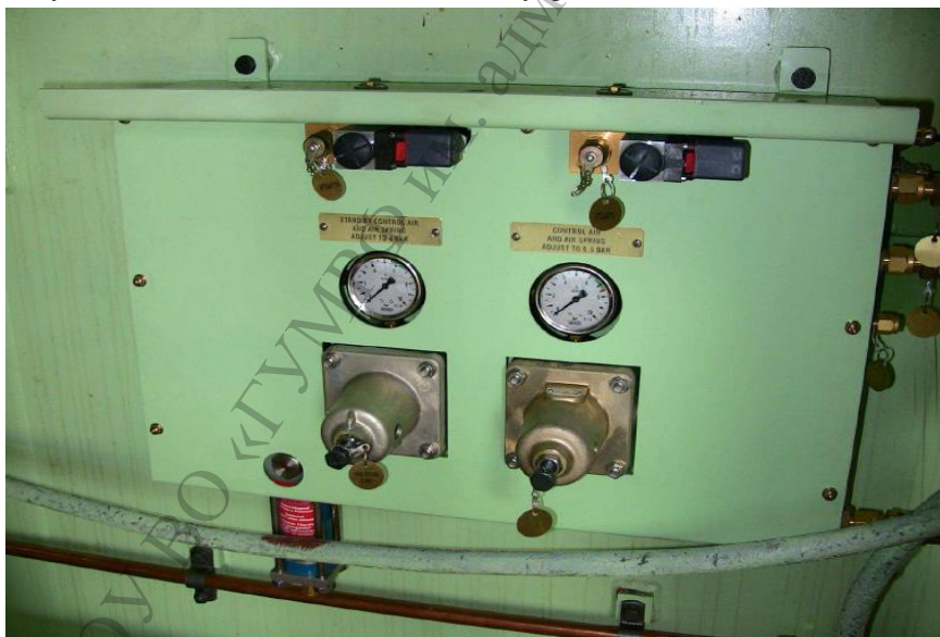
Рисунок 1.37 - Control air supply unit (CASU) – «компоненты» управления пуском сжатым воздухом
