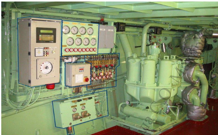
Рисунок 1.36 - LCS – «Машинный» пост управления
