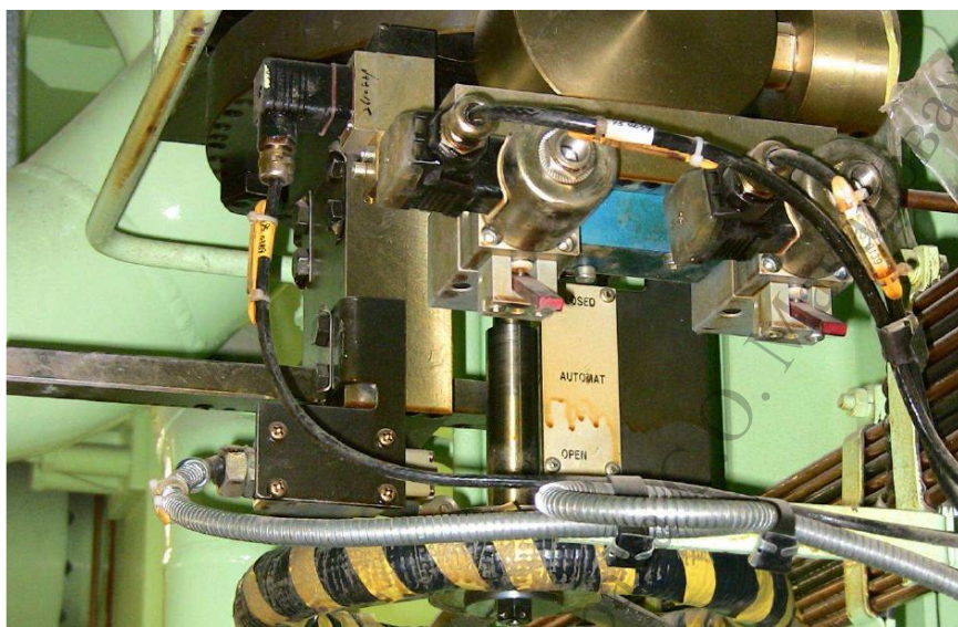
Рисунок 1.39 - Main starting valve (MSV) – Главный клапан Пуска в Starting air (SA) в CASU
