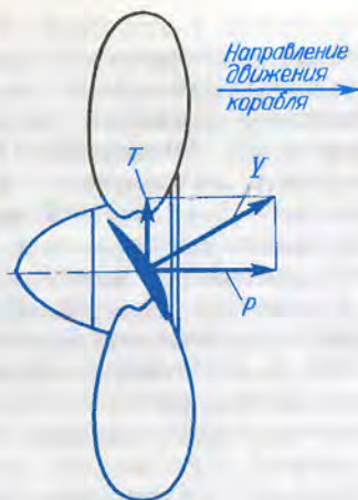
Схема создания упора при работе гребного винта T — окружная составляющая силы сопротивления вращению лопасти; Y — гидродинамическая сила; P — сила упора
