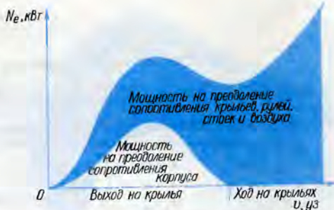
Характер распределения мощности при движении судна на подводных крыльях
