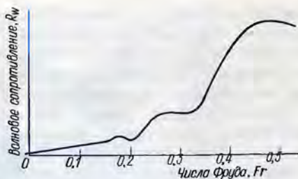
Характер зависимости волнового сопротивления от скорости корабля
