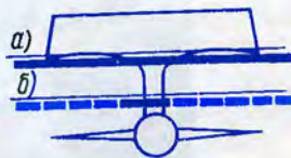
Проектное изображение полупогружного корабля типа HYSWAS: а — ватерлиния в режиме «Стоп»; б — ватерлиния на ходу
