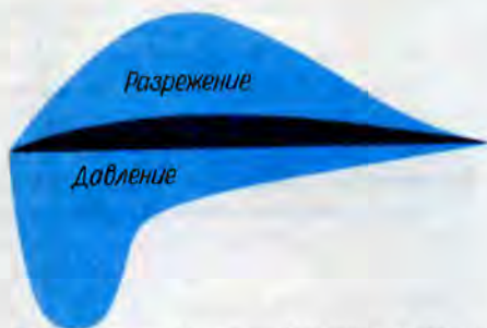
Эпюра распределения давления и разрежения на подводном крыле
