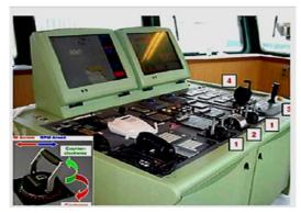
Рис. 6.8. Панель управления судна оснащенного двумя модулями AZIPOD
