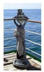
Курсы и пеленги, определяемые относительно гирокомпасного меридиана, называются гирокомпасными. Существует следующая зависимость:
