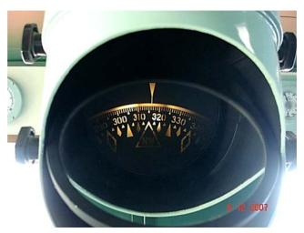
Рис. 2.4. Картушка магнитного компаса, наблюдаемая через оптическую систему
