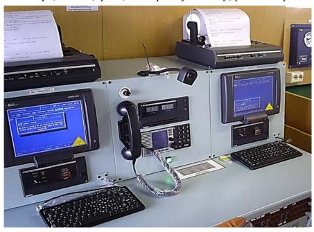
Рис. 2.7. Аппаратура ГМССБ
