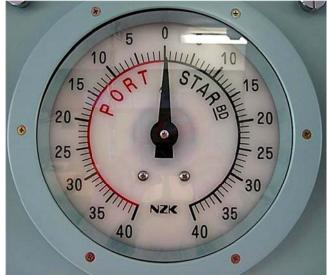
Рис. 2.4. Индикатор аксиометра – прибора, указывающего положение пера руля относительно ДП судна
