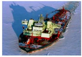
Рис. 6.7. Танкер двойного действия – Double Acting Tanker (DAT) TEMPERA
