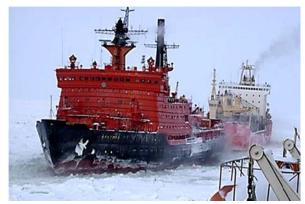
Рис. 6.60. Буксировка транспортного судна
