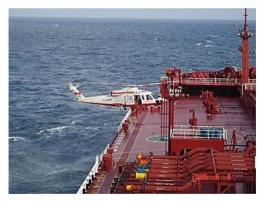
Для предотвращения скольжения вертолета после посадки следует застелить площадку грузовой сетью из пенькового троса, которая должна быть прочно закреплена. Место посадки обозначить буквой "Н", выложенной белыми полотнищами. В темное время суток подсветить место посадки, вымпел, мачты, трубы, рубки, но так, чтобы освещение не ослепляло пилота. До посадки вертолета люди должны быть удалены с площадки. Судно сохраняет постоянными курс и
