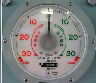
Рис. 2.5. Индикатор тахометра — прибора, предназначенного для определения угловой скорости вращения судна
