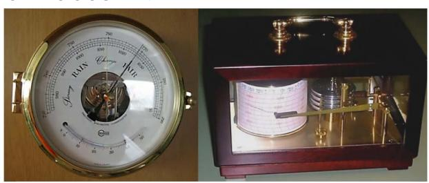
Рис. 4.12. Приборы для измерения атмосферного давления: барометр-анероид и барограф
