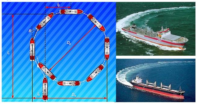
Рис. 1.21. Траектория судна на циркуляции
