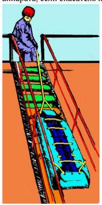
*Многоцелевые носилки*, предназначенные для использования на борту судна, удобны в обращении, обеспечивают надежную опору для тела пострадавшего и особенно полезны при эвакуации из узких мест, когда приходится преодолевать сложные повороты или когда пострадавшего необходимо поднять на определенную высоту (например, из трюма на палубу).
