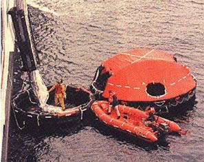
Рис. 8.24. Морская эвакуационная система
