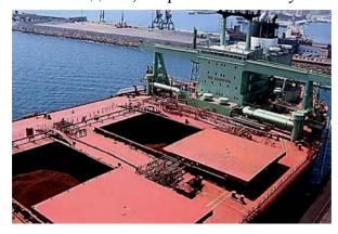
Рис. 6.76. Откатываемые закрытия на балкере
