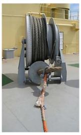
Стальные тросы применяются все реже, так как они плохо воспринимают динамические нагрузки, требуют больших физических усилий при передаче с борта судна на причал. Наиболее распространенными на морских судах являются стальные швартовы диаметром от 19 до 28 мм. Хранят стальной швартов на ручных вьюшках, оборудованных тормозом, прижимаемым педалью к щеке барабана. На крупнотоннажных судах устанавливают швартовные вьюшки с приводом.
