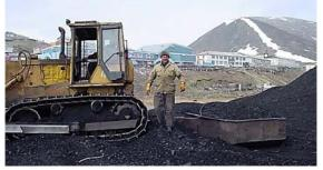
В контейнер можно грузить любого рода груз как насыпной, так и штучный, за исключением габаритных тяжеловесов, для выгрузки которых судно снабжают «волокушами». Контейнер изготовляется из стали и имеет крепления для выгрузки его с грузом на баржу, буксировки и переворачивания на берегу. Он водонепроницаем и в по-
