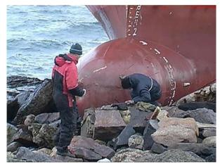
Заделка разошедшихся швов. Разошедшиеся швы и трещины, небольшие узкие разрывы в обшивке могут заделываться клиньями, подушками из пакли, заполняться специальными мастиками и замазками.
