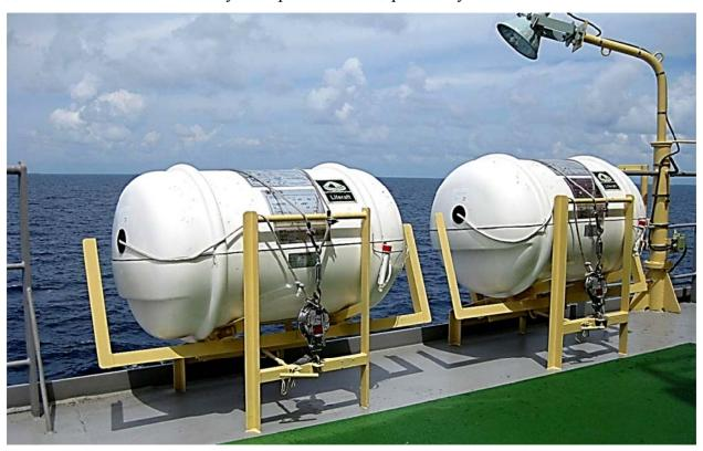
Рис. 8.18. Установка ПСН на борту судна
