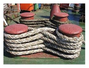
Рис. 6.37. Крепление швартовного троса на кнехте
