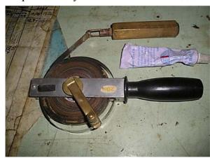
Рис. 7.5. Рулетка для измерения уровня жидкости
