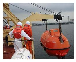
Рис. 8.14. Посадка экипажа и спуск шлюпки
