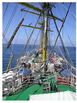
**Рангоут и такелаж**. Рангоут — совокупность судовых конструкций из стальных труб, деревянных или металлических балок, предназначен для крепления грузовых стрел, антенн, средств связи и сигнализации.
