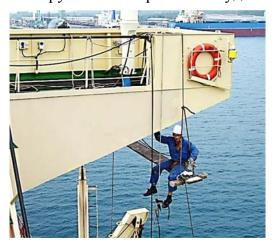
На время проведения забортных работ и работ на высоте назначают наблюдающего, который следит за безопасностью работы. У места выполнения забортных работ должен находиться спасательный круг с бросательным концом длиной не менее 25 метров. Спускать, поднимать и переносить забортную беседку можно только при отсутствии на ней людей. Сходить с палубы на беседку и с беседки на палубу можно только по штормтрапу.
