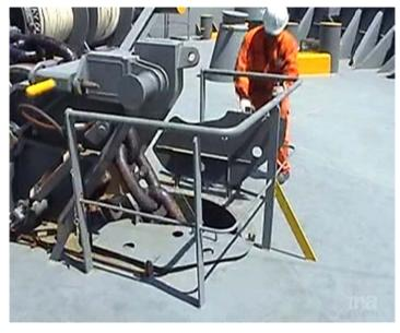
Для уборки якоря noпоходному якорную цепь зажимают палубным стопором накладывают цепные стопоры; затем закрывают задвижными щитами якорные клюзы и задраивают палубные. Пост управления электрическим брашпилем закрывают чехлом. Палубные клюзы при коротких переходах закрывают крышками или парусиновыми чехлами – брюканцами. На дальних переходах, особенно в штормовых условиях плавания, палубные клюзы рекомендуется цементировать:
