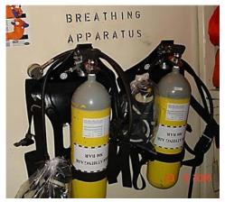
Изолирующие оыхательные аппараты на сжатом воздухе АСВ-2 ДРЕГЕР предназначены для защиты органов дыхания и зрения человека при работе в атмосфере, непригодной для дыхания (повышенная концентрация отравляющих веществ или обедненная кислородом атмосфера) и при работе под водой на глубине до 20 метров.
