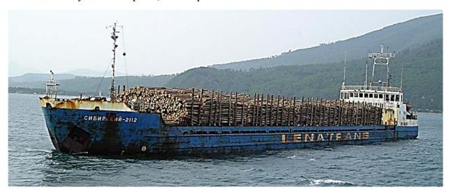
Рис. 1.9. Лесовоз (Timber carrying vessel)
