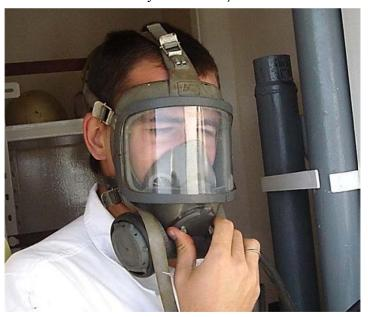
Рис. 7.13. Использование аварийного дыхательного устройства
