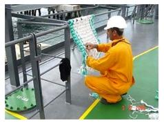
Синтетические тросы имеют недостатки и особенности, которые необходимо учитывать при их эксплуатации. Полиамидные тросы повреждаются при воздействии солнечной радиации, кислот, олифы, мазута и др. Полиэфирные тросы разрушаются от соприкосновения с концентрированными кислотами и щелочами. Разрывная прочность полипропиленовых тросов снижается при температурах свыше  $+20^{\circ}$ , а при отрицательных температу-
