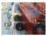
**Кранцы** применяют для предохранения корпуса судна от повреждения при швартовке. Мягкие кранцы чаще всего делают плетеными из старого растительного троса. Применяют также пробковые кранцы, представляющие собой небольшой шаровидный мешок, заполненный мелкой пробкой. В последнее время все более широкое применение находят пневматические кранцы.
