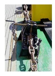
Рис. 6.19. Винтовой стопор
