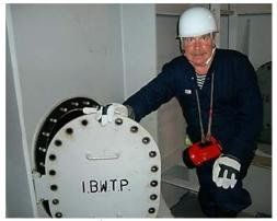
В большинстве случаев танки располагаются в двойном дне, и их горловины выходят на *пайолы* трюмов. Горловины закрываются крышками на шпильках или болтах и для создания водонепроницаемости имеют резиновые прокладки. Для предохранения от повреждений шпильки и сами крышки ограждаются *комингсами* и закрываются сверху небольшими деревянными *лючинами*, сделанными в уровень с пайолом трюма. Однако очень часто во время перегрузочных опе-
