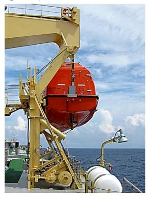
Рис. 8.9. Крепление спасательной шлюпки на борту судна
