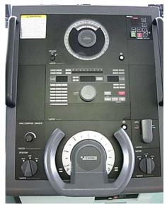
Рис. 2.2. Рулевая колонка судна
