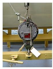
Рис. 8.22. Гидростат разобщающего типа
