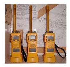
Рис. 8.10. Радиолокационный маяк-ответчик (SART) и переносные УКВ радиостанции
