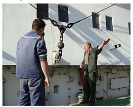
Рис. 6.67. Соединение грузовых шкентелей при работе на «телефон»
