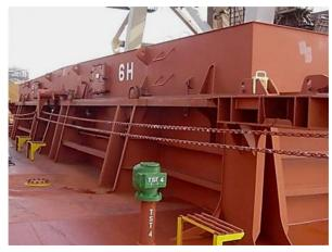
Рис. 6.74. Откидное люковое закрытие с гидроприводом:
