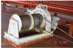
**Стальные тросы** изготовляют из оцинкованной стальной проволоки диаметром от 0,2 до 5 миллиметров. По конструкции стальные тросы делятся на три типа: одинарной, двойной и тройной свивки (рис. 5.2).
