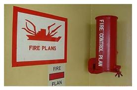
Рис. 7.12. Контейнер со схемами противопожарной защиты судна
