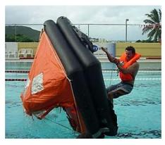
Не исключено, что после раскрытия контейнера и надувания плот окажется на воде перевернутым вверх дном. При этом он будет накренен на тот край, на котором закреплен газовый баллон. Чтобы привести плот в нормальное положение, нужно развернуть его повышенным краем против ветра и взобраться на днище, став ногами на газовый баллон. Руками взяться за лямки, пришитые к днищу. Сделав глубокий вдох и задержав дыхание, резким рыв-
