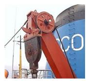
Для того чтобы исключить возможность спуска шлюпки до момента ее полного вываливания за борт, на шлюпбалке имеется рог, на который навешивают серьгу подвижного блока шлюпталей. Длину и форму рога выбирают таким образом, чтобы подвижный блок спадал с него только при нижнем предельном положении шлюпбалки.
