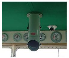
Рис. 3.2. Зеркальный отражатель магнитного компаса
