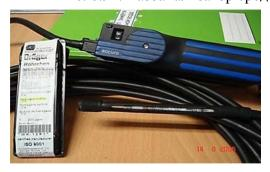
Рис. 6.93. Ручной насос с трубками драгер
