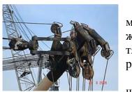
Гини - многошкивные тали, основанные толстым тросом между большими по размерам блоками, способные выдерживать большие нагрузки. Применяются при вооружении тяжеловесных стрел (грузовые гини), а также в ряде аварийных случаев, например, при снятии судна с мели и т. п.
