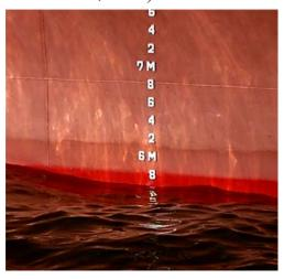
Рис. 1.23. Марки углубления: на левом рисунке осадка равна 12 м 10 см; на правом – 5 м 75 см
