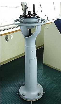
Рис. 3.5. Репитер гирокомпаса с пеленгатором, установленный на пелорусе
