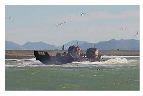
Рейдовые портпункты нередко располагаются на реках, впадающих в море. Убежища для плавсредств, причалы для их погрузки и разгрузки сооружают в устьях рек или лагунах. Вывод плавсредств в море и ввод их в портпункт обычно связаны с прохождением мелководного бара и возможны только при отсутствии волнения.
