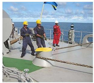
Рис. 6.46. Удержание швартовного троса стопором
