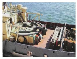
Рис. 6.51. Буксирное устройство судна — буксировщика: 1 – буксирный трос; 2 – буксирный клюз; 3 – мягкий кранец; 4 – буксирная арка; 5 – битенг; 6 – буксирная лебедка; 7 – буксирный гак; 8 – погон; 9 - буксирная дуга
