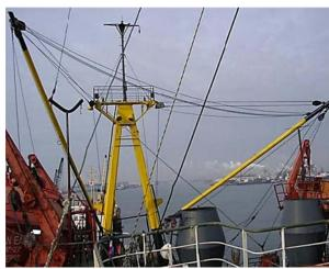
Рис. 6.68. Работа легкими стрелами на «телефон»: 1 – оттяжки; 2 – контроттяжки; 3 – гак; 4 – топрик; 5 – грузовые шкентели
