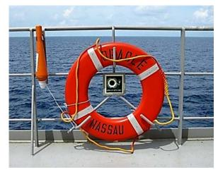
Рис. 8.2. Спасательные круги со спасательным линем и с самозажигающимся огнем
