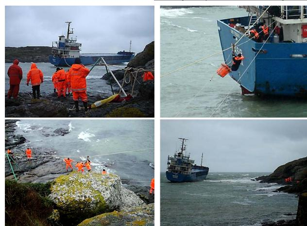
Рис. 8.25. Канатная переправа для снятия людей с гибнущего судна
