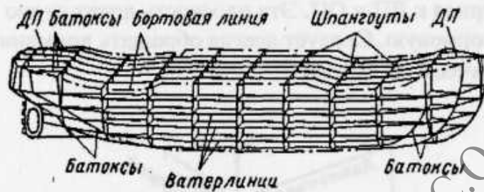
Рис. 2. Сечение теоретической наружной поверхности корпуса судна вспомогательными плоскостями
