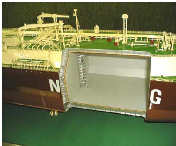
Рис. 11.35. Грузовое помещение танкера-газовоза в виде танка
