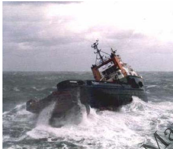
Рис. 4.18. Штормование судна на носовых курсовых углах.
