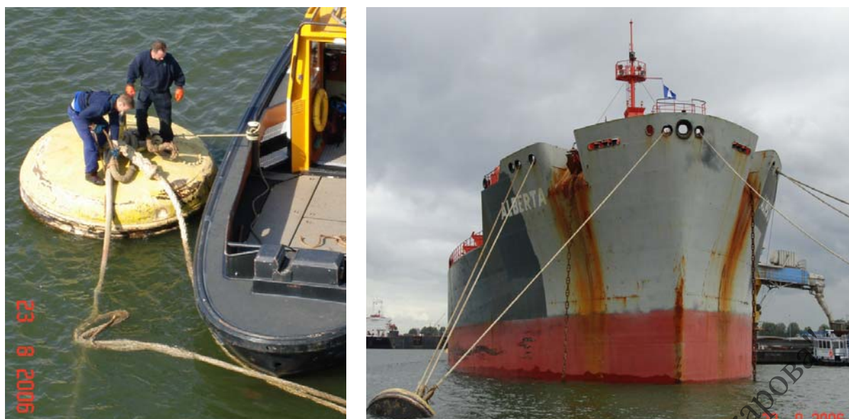
Рис. 2.34. Крепление троса к швартовной бочке
