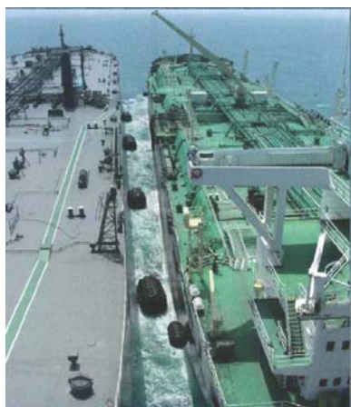
Рис. 3.48. Процесс швартовки двух судов на ходу
