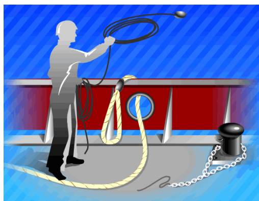
Рис. 3.11. Подготовленное для швартовки рабочее место: 1- трос; 2 - выброска; 3 - переносной цепной стопор
