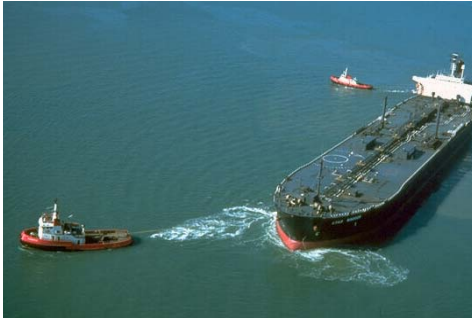
Рис. 3.37. Буксировка судна при помощи буксирных тросов
