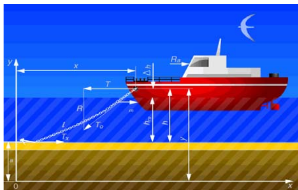
Рис. 2.21. Схема сил, действующих на судно, стоящее на якорю
