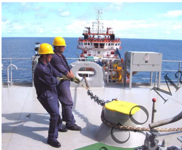
Рис. 3.16. Удержание швартового троса стопором
