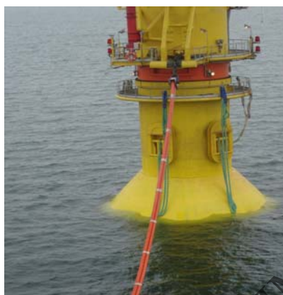
Рис. 11.25. Соединение грузового шланга с ВОП
