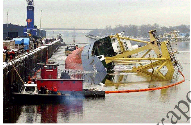
Рис. 3.44. Потеря судном остойчивости во время грузовых операций
