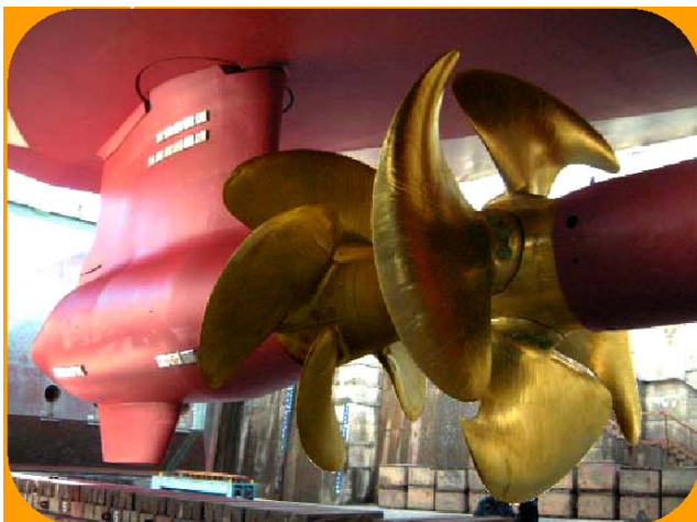
Рис. 1.26. Система CRP AZIPOD
