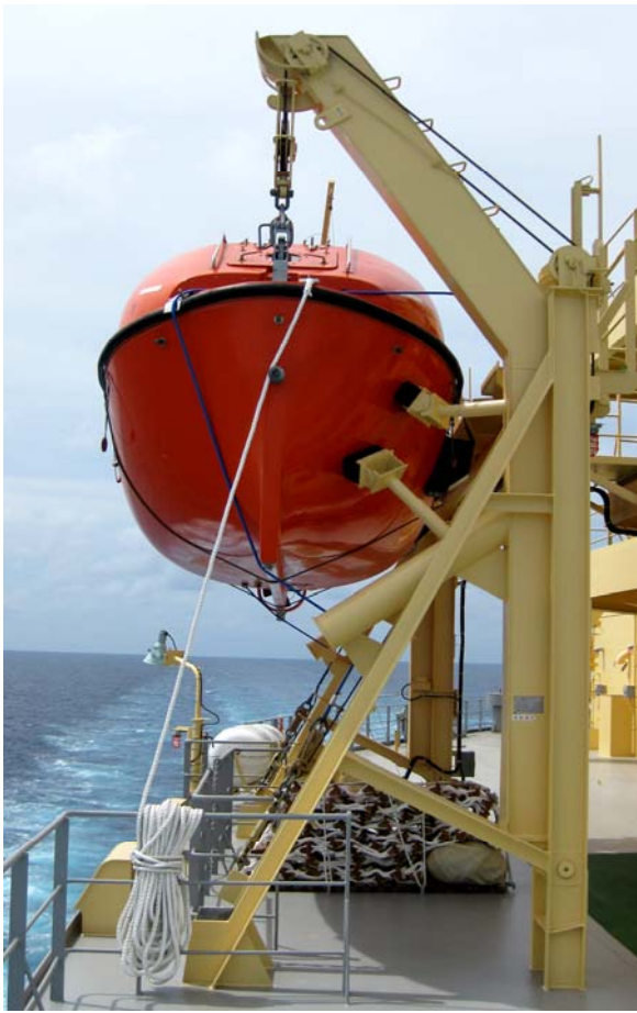
Рис. 14.8. Крепление спасательной шлюпки на борту судна
