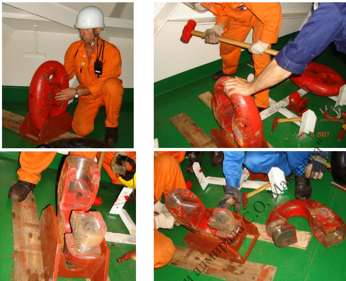
Рис. 2.7. Разборка звена Кентера
