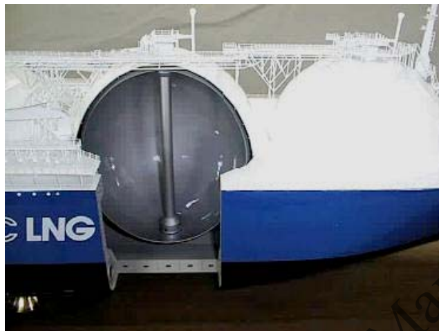
Рис. 11.36. Грузовое помещение танкера-газовоза в виде цистерны
