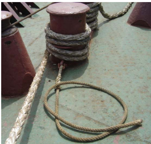
Рис. 3.15. Крепление переносного стопора к кнехту
