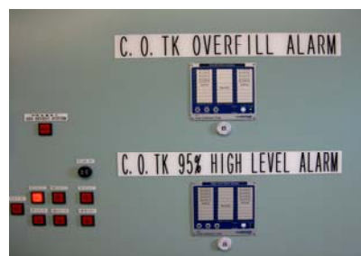
Рис. 11.31. Датчики заполнения грузовых танков
