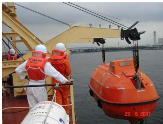
Рис. 14.13. Посадка экипажа и спуск шлюпки
