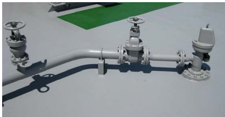
Рис. 11.11. Схема стационарной моечной машинки и ее управление на палубе танкера
