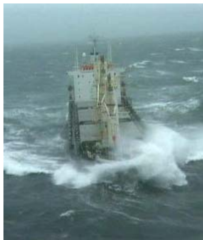
Рис. 4.13. Зарывание носовой части корпуса судна во встречную волну
