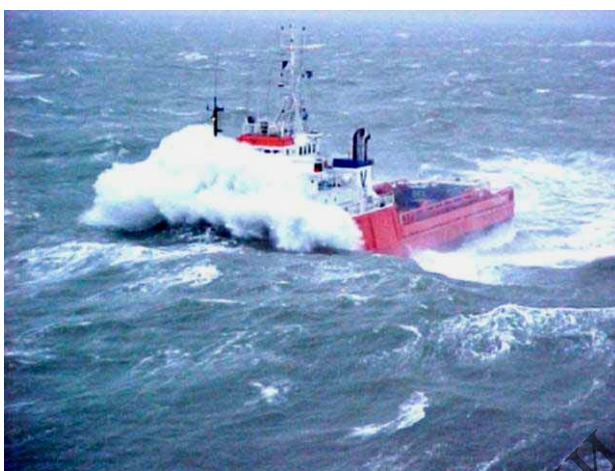
Рис. 4.12. Заливание палубы судна во время шторма
