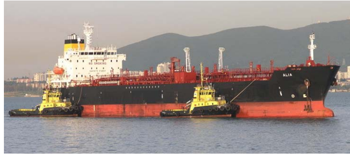
Рис. 3.38. Работа буксиров способом «пуш-пул»
