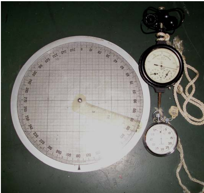
Рис. 4.4. Приборы для определения скорости и направления ветра: 1 – круг СМО, секундомер и анемометр; 2 – автоматическая метеостанция
