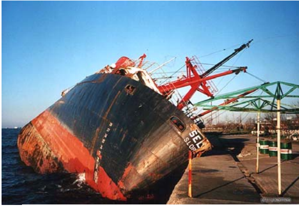
Рис. 3.44. Потеря судном остойчивости во время грузовых операций
