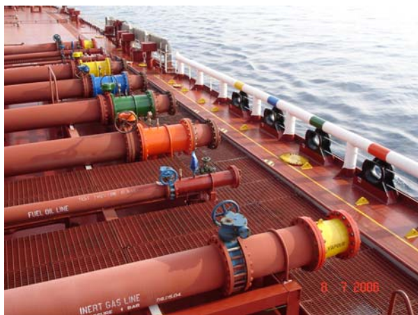
Рис. 11.29. Центральный манифольд нефтеналивного танкера
