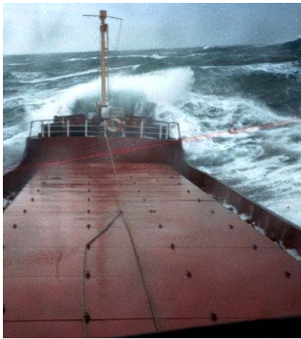
Рис. 4.18. Штормование судна на носовых курсовых углах.
