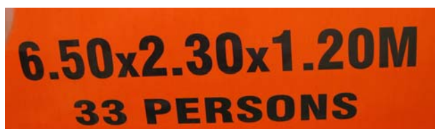
Рис. 14.4. Маркировка спасательной шлюпки
