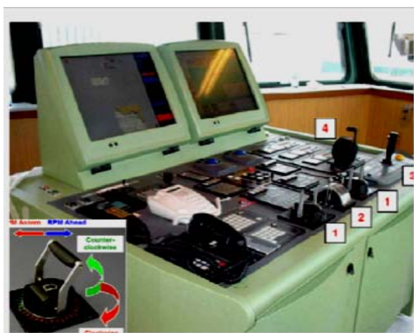
Рис. 1.27. Панель управления судна оснащенного двумя модулями AZIPOD: 1 - рычаги управления; 2 – телеграф; 3 – джойстик; 4 – рычаг управления подруливающим устройством.
