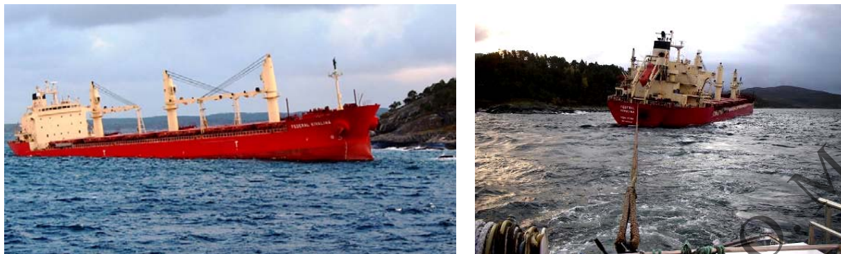
Рис. 7.8. Снятие судна с мели буксировкой
