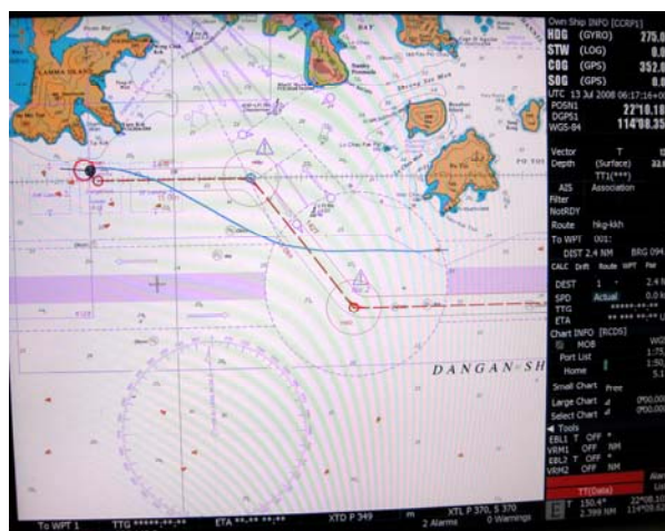
Рис. 2.19. Место якорной стоянки на навигационной и электронной картах
