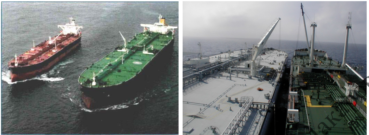
Рис. 3.50. Швартовка с «траверзного расстояния»
