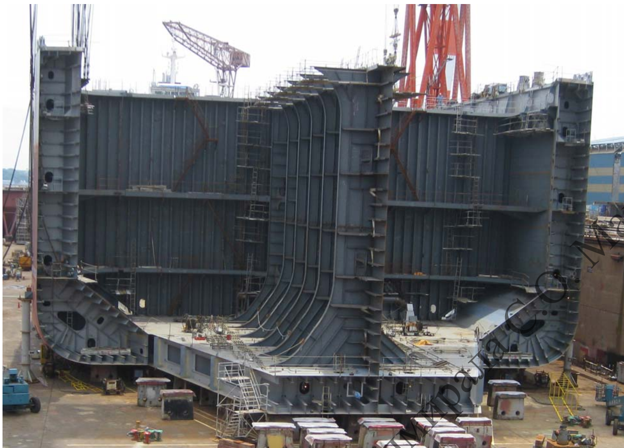
Рис. 11.4. Корпус танкера на стапелях
