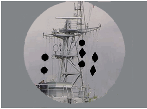
Рис. 16.17. Отличительные огни и знаки дноуглубительного судна
