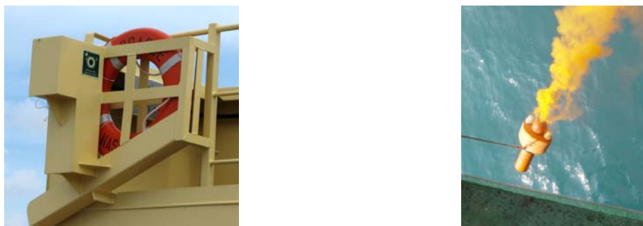
Рис. 14.23. Круг с самозажигающимся огнем и дымовой шашкой
