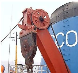
Лопари – стальные тросы, прикрепленные к шлюпке в ее оконечностях и проведенные на лебедку, предназначенные для спуска и подъема шлюпки. Лопари должны периодически тироваться.
