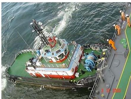
Рис. 3.36. Работа буксиров «пуш-пул» (на битенг)
