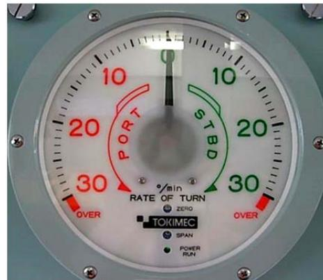
Рис. 17.9. Индикатор тахометра – прибора, предназначенного для определения угловой скорости вращения судна
