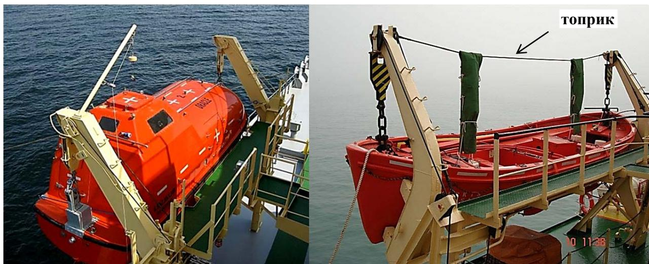
Рис. 12.7. Спасательные шлюпки закрытого и открытого типов
