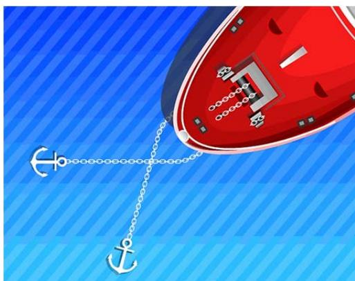
Рис. 2.41. Перекручивание якорных цепей (крест)
