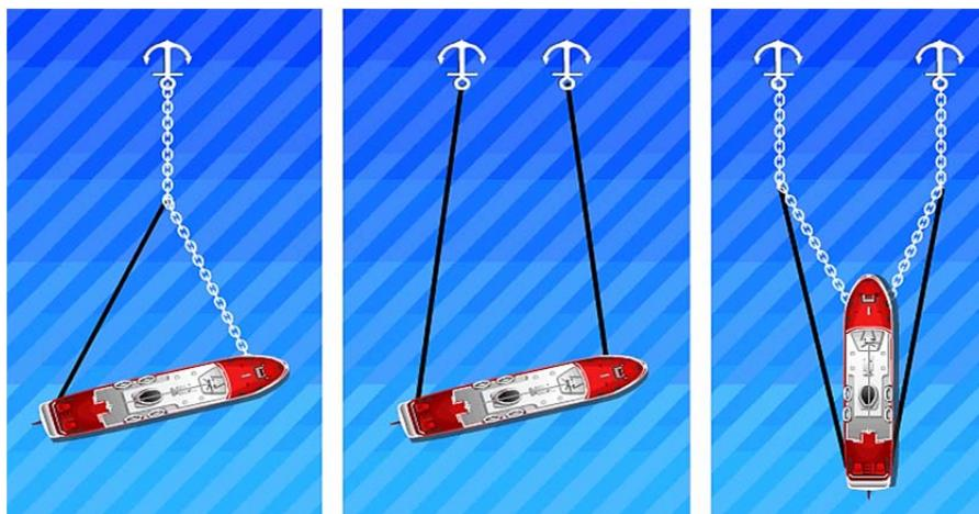
Рис. 2.30. Постановка судна на шпринг
