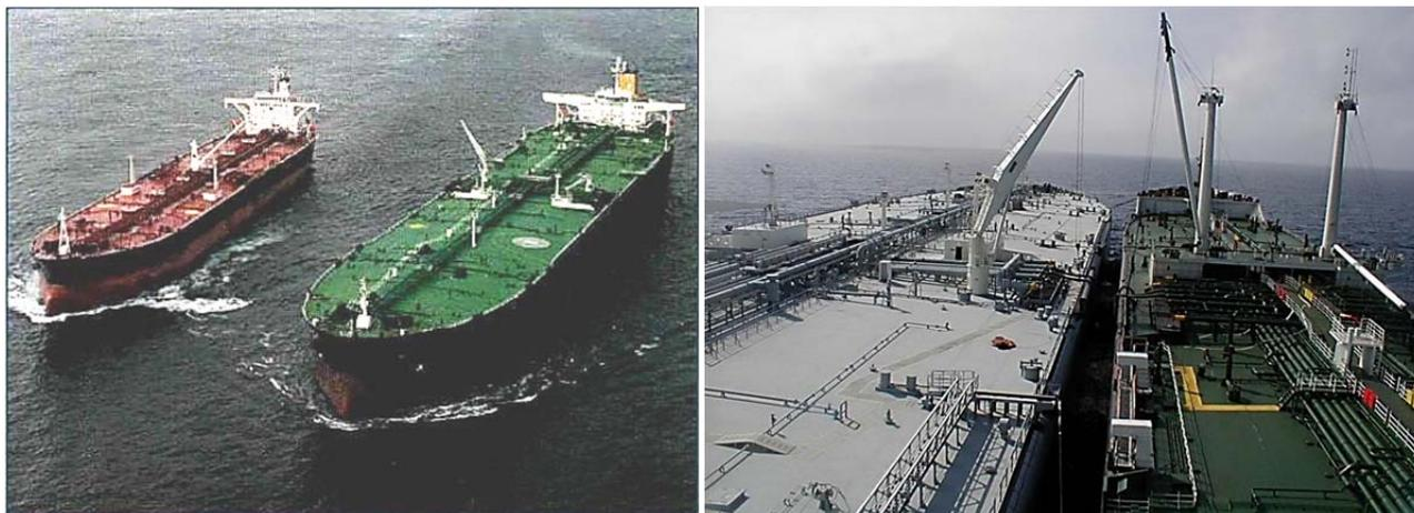
Рис. 3.47. Швартовка с «траверзного расстояния»
