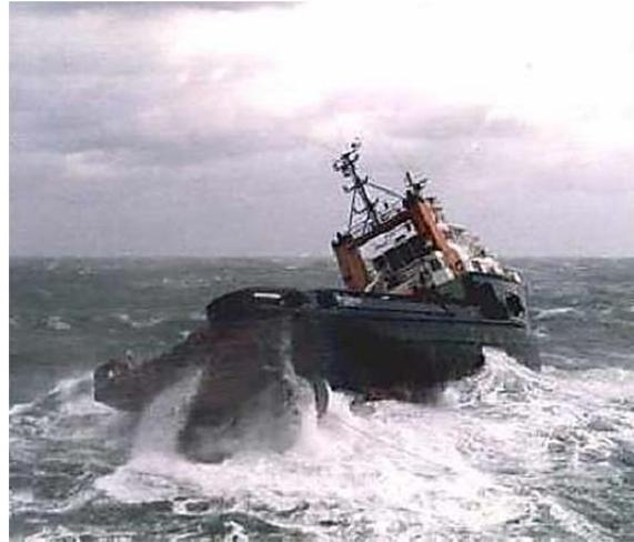
Рис. 4.13. Штормование судна на носовых курсовых углах
