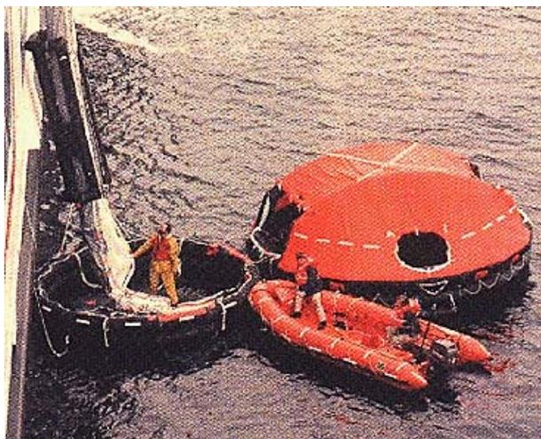
Рис. 12.25. Морская эвакуационная система
