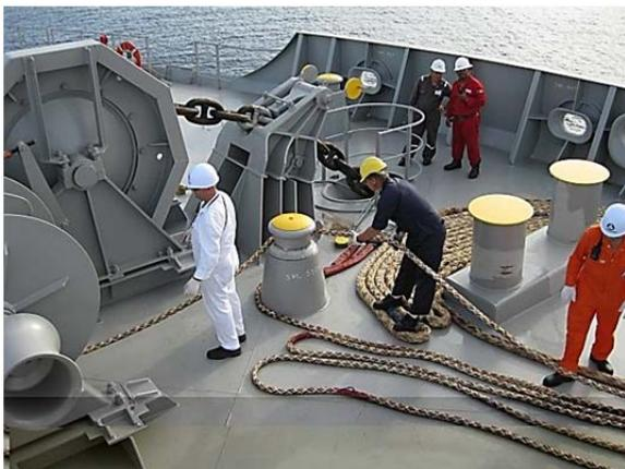
3. При наличии автоматических швартовых лебедок и швартовых поворотных клюзов следует периодически проворачивать ролики клюзов и регулярно смазывать трущиеся части.
