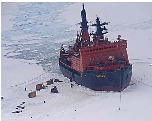
Рис. 6.13. Заводка троса с ледовым якорем для кренования судна:
