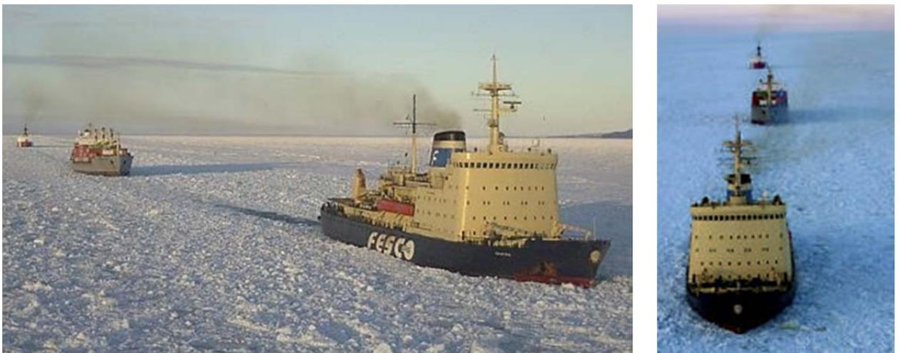
Рис. 6.16. Проводка ледоколом каравана судов
