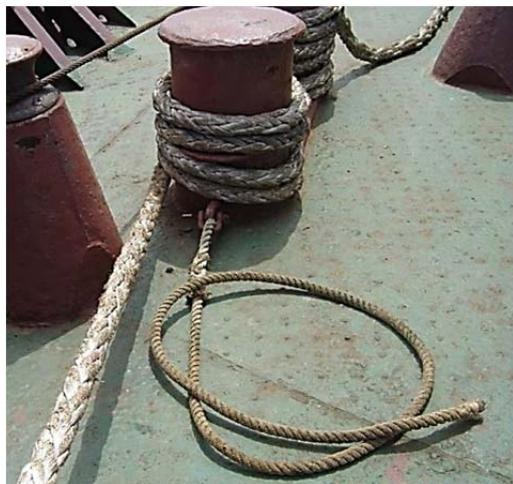
Рис. 3.15. Крепление переносного стопора к кнехту
