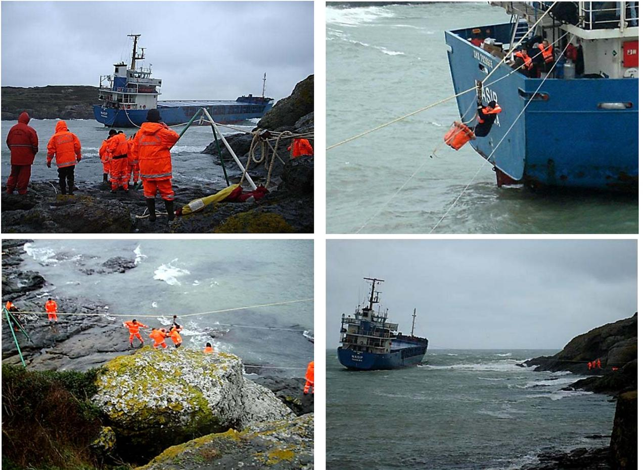
Рис.14.21. Канатная переправа для снятия людей с гибнущего судна
