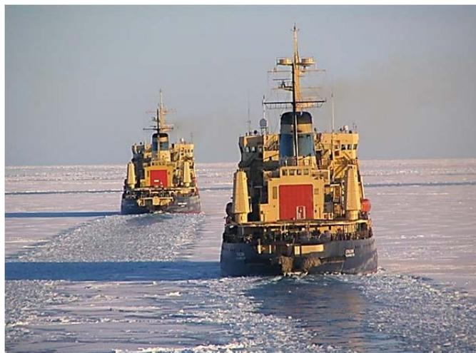
Исчисление ледовой паспортной скорости производится на полигонах, где судно совершает пробеги на определенных режимах работы энергетической установки по участкам от 1 – 2 длин корпуса до 1,0 – 1,5 мили. Максимальные значения определяются либо мощностью двигателя (для ледоколов и транспортных судов с прочными корпусами), либо прочностью корпуса (для судов со слабыми корпусами). Во всех случаях *допустимая и допустимая скорости*
