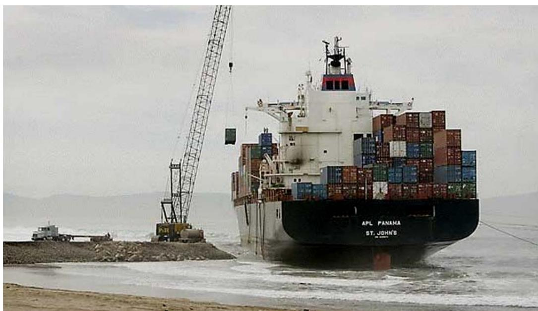
Рис. 7.6. Снятие с мели способом разгрузки судна
