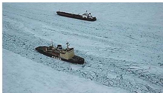
Рис. 6.19. Работа ледокола по прокладыванию канала
