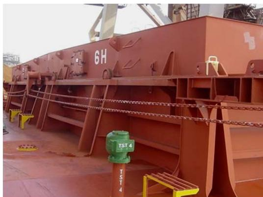
Рис. 10.11. Откидное люковое закрытие с гидроприводом:
