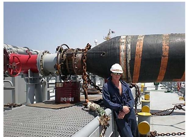
Рис. 11.24. Центральный манифольд нефтеналивного танкера
