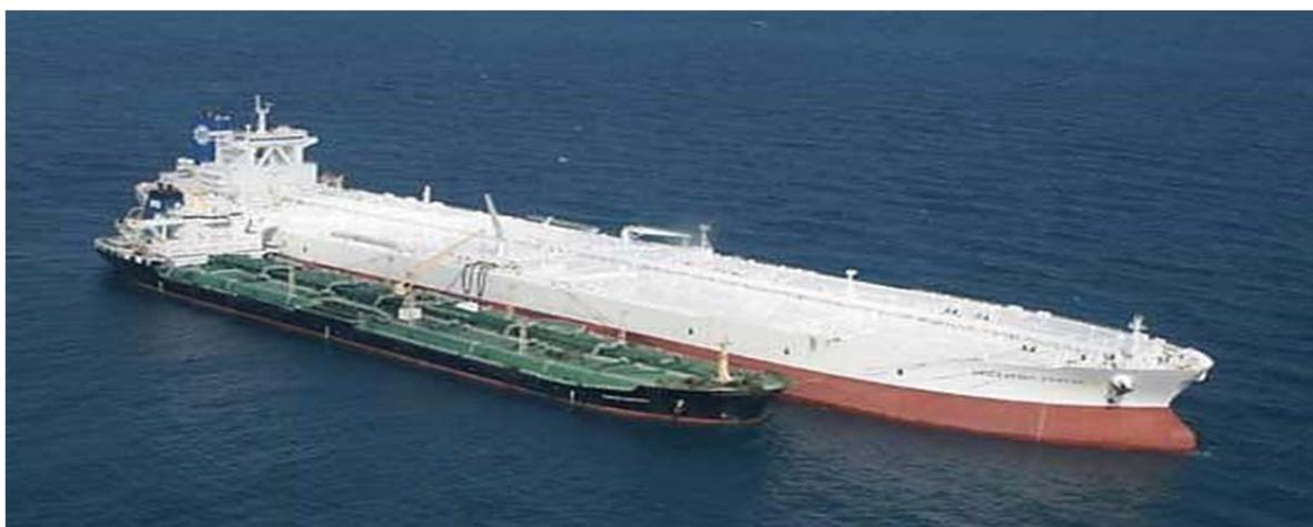
Рис. 3.50. Швартовка к судну в дрейфе
