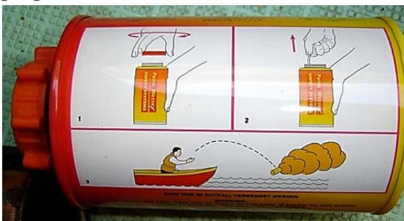
*Звуковая ракета* предназначена для подачи сигнала бедствия, взрываясь на высоте имитирует пушечный выстрел. Звуковую ракету запускают только из пусковых стаканов, укрепленных на планшире или леерном ограждении на обоих крыльях мостика. При несрабатывании ракеты ее разрешается извлечь из стакана не менее чем через 2 минуты.
