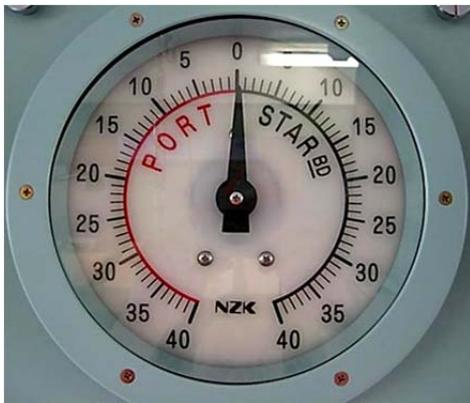
Рис. 17.8. Индикатор аксиометра – прибора, указывающего положение пера руля относительно ДП судна
