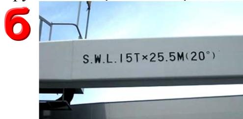
Рис. 10.10. Маркировка: а – грузовой стрелы; б – грузового крана
