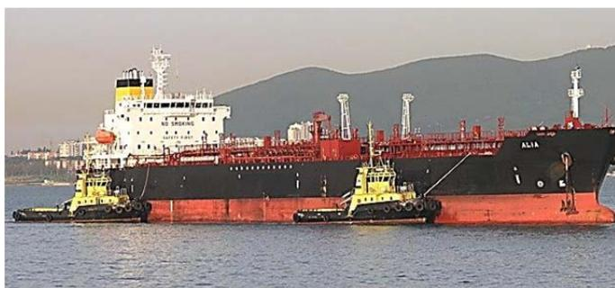
Рис. 3.35. Работа буксиров способом «пуш-пул»
