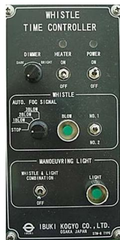
Рис. 13.2. Панель прибора для подачи туманных сигналов
