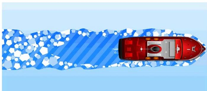
Рис. 6.18. Схема канала за ледоколом в сплошном льду
