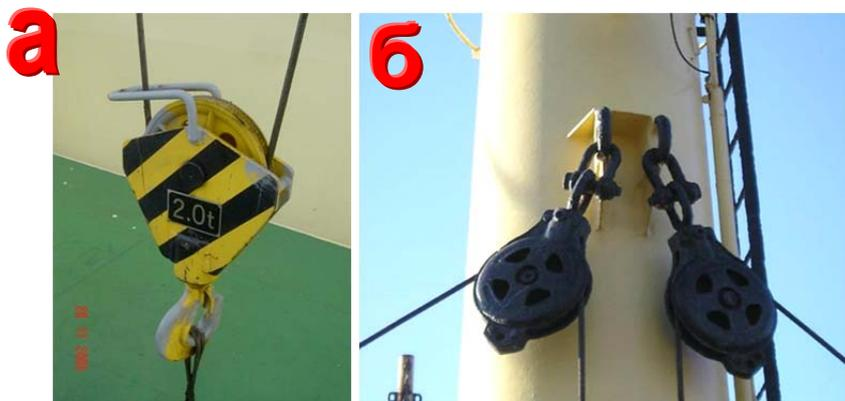
Рис. 10.3. а – грузовой гак; б - поворотные оттяжки
