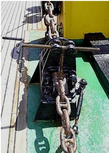
Рис. 2.12. Винтовой стопор
