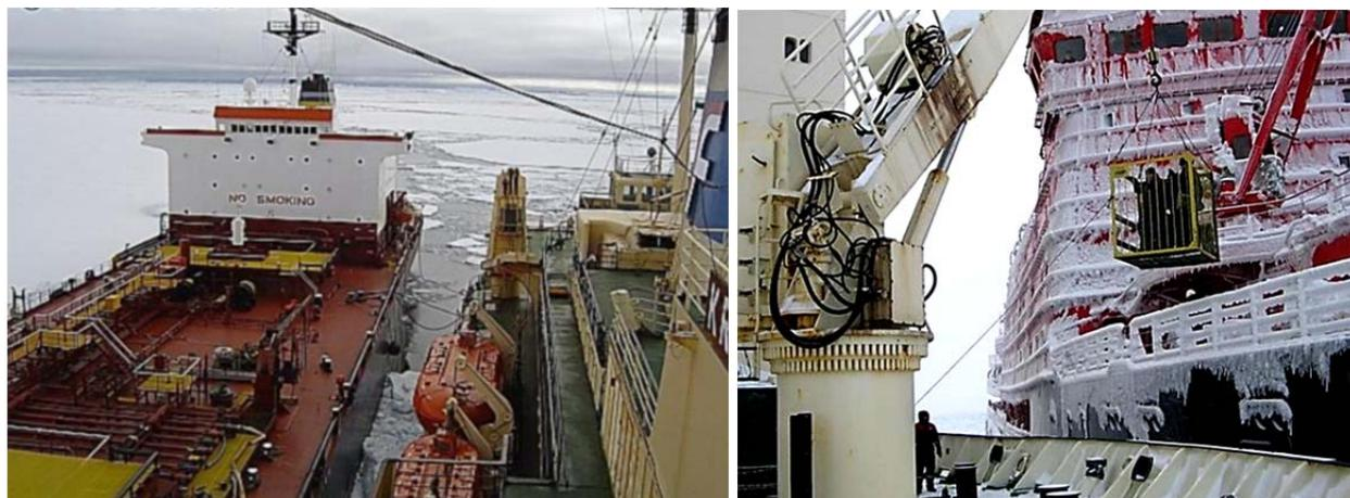
Рис. 6.21. Швартовка ледокола к транспортному судну
