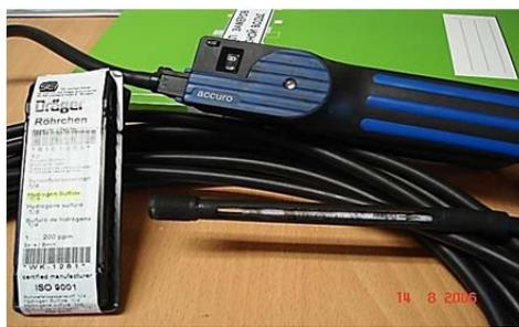
Рис. 11.15. Ручной насос с трубками драгер
