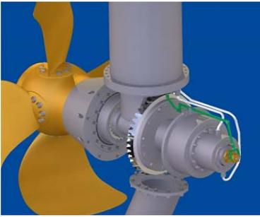
*Винт регулируемого шага* — это гребной винт, у которого регулируется угол разворота лопастей. Лопасти такого винта разворачиваются специальным механизмом в любое положение в диапазоне «полный вперед — стоп—полный назад», т. е. в зависимости от степени разворота лопастей, не изменяя работы главного двигателя, судну можно придать или движение вперед, или остановиться на месте, или создать движение назад.
