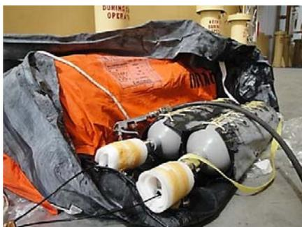
Для надувания плота к его днищу крепится баллон с нетоксичным газом, закрытый специальным *пусковым клапаном*, который открывается при натяжении прикрепленного к нему пускового линия. При открытии пускового клапана газ заполняет отсеки в течение 1 – 3 минут.
