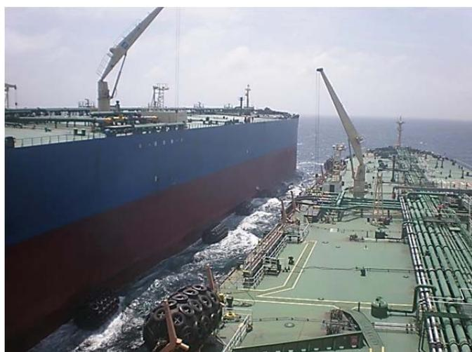
Кранцы применяют для предохранения корпуса судна от повреждения при швартовке. Мягкие кранцы чаще всего делают плетеными из старого растительного троса. Применяют также пробковые кранцы, представляющие собой небольшой шаровидный мешок, заполненный мелкой пробкой. В последнее время все более широкое применение находят пневматические кранцы.
