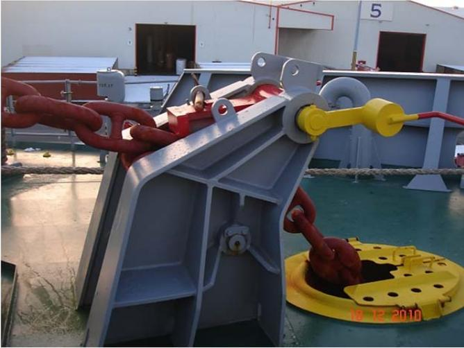
Для уборки якоря по-походному якорную цепь зажимают палубным стопором и накладывают цепные стопоры; затем закрывают задвижными щитами якорные клюзы и задраивают палубные. Пост управления электрическим брашпилем закрывают чехлом. Палубные клюзы при коротких переходах закрывают крышками или парусиновыми чехлами – *брюканцами*. На дальних переходах, особенно в штормовых условиях плавания, палубные клюзы рекомендуются
