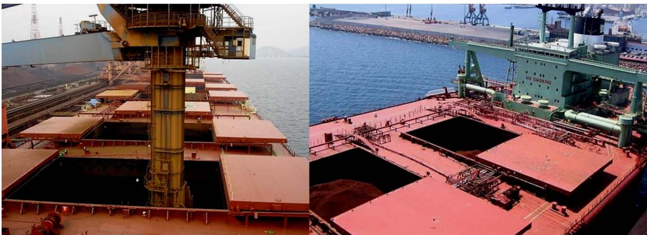
Рис. 10.13. Откатываемые закрытия на балкере
