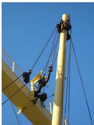
Нок стрелы поддерживается *топенантом*. Изменяя длину топенанта, можно изменить угол подъема стрелы. Топенант состоит из стального троса, коренной конец которого крепится к верхнему обуху нокового бугеля. Второй, ходовой конец топенанта проходит через *топенант-блок*, закрепленный на мачте. Ниже блока к топенанту крепится треугольное звено — *треугольник топенанта*. С другой стороны к треугольнику прикреплены длиннозвенная цепь — *грузовой стопор* и стальной трос — *лопарь топенанта*.
