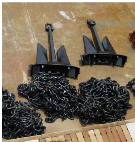
**Якоря**, применяемые на судах (рис. 2.2), по конструкции разделяются на три большие группы:
