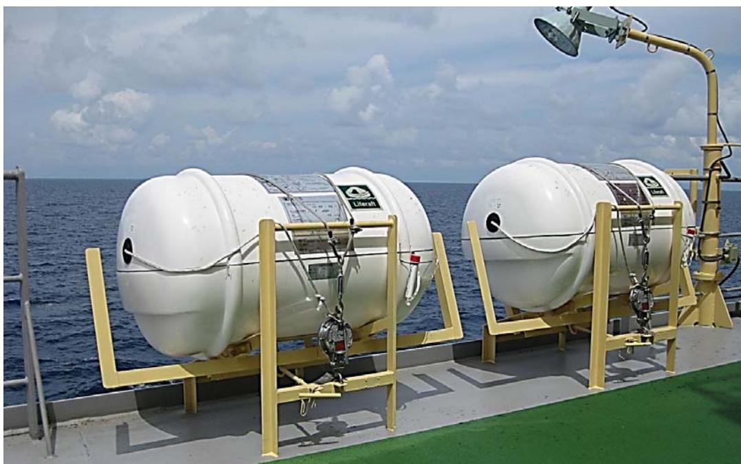
Рис. 12.19. Установка ПСН на борту судна
