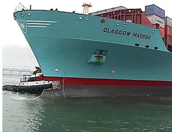
Рис.3.20. Неудачная швартовка судна
