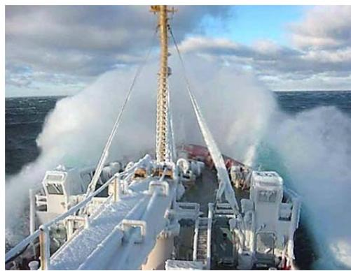
Рис.4.17. Заливание судна
