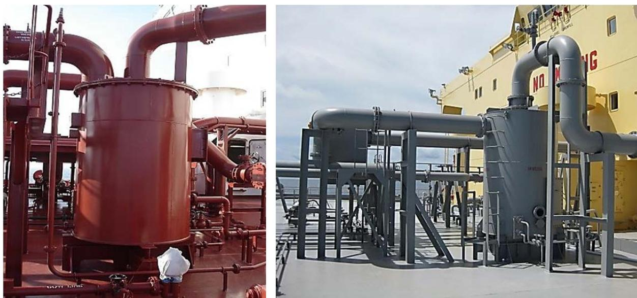
Рис. 11.16. Палубный гидравлический затвор
