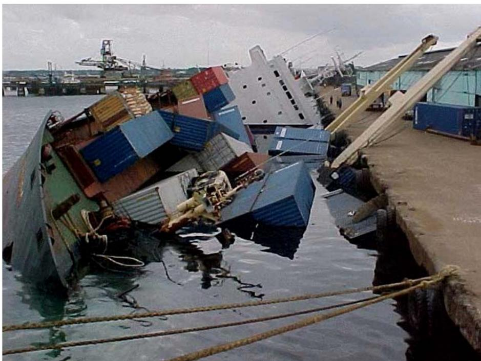
Рис. 10.17. Потеря остойчивости при неправильной погрузке судна
