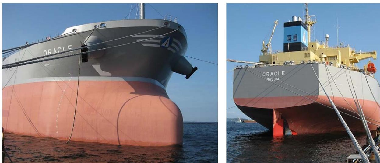
Рис. 1.28. Носовые и кормовые обводы танкера
