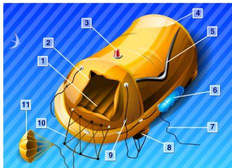
установки тента, состоящего из двух слоев водонепроницаемого материала с воздушной прослойкой. Наружный цвет тента делается оранжевым. Для установки тента в надувных плотках делаются опоры арочного типа, надувающиеся автоматически вместе с камерой плавучести. Высота тента делается такой, чтобы человек мог находиться в сидячем положении в любой части подтентового пространства.
