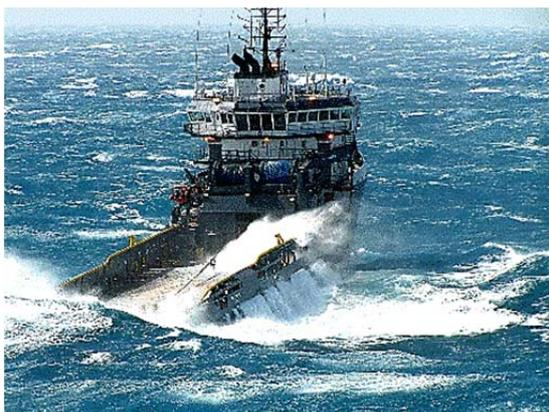
Величинами, характеризующими качку, являются *угол наклона судна* и *период*, за который совершается одно полное колебание судна. Качка тем стремительнее, чем больше углы наклона и меньше период. Качка зависит от загрузки судна (остойчивости), характера волнения, скорости движения судна и курсового угла бега волн.
