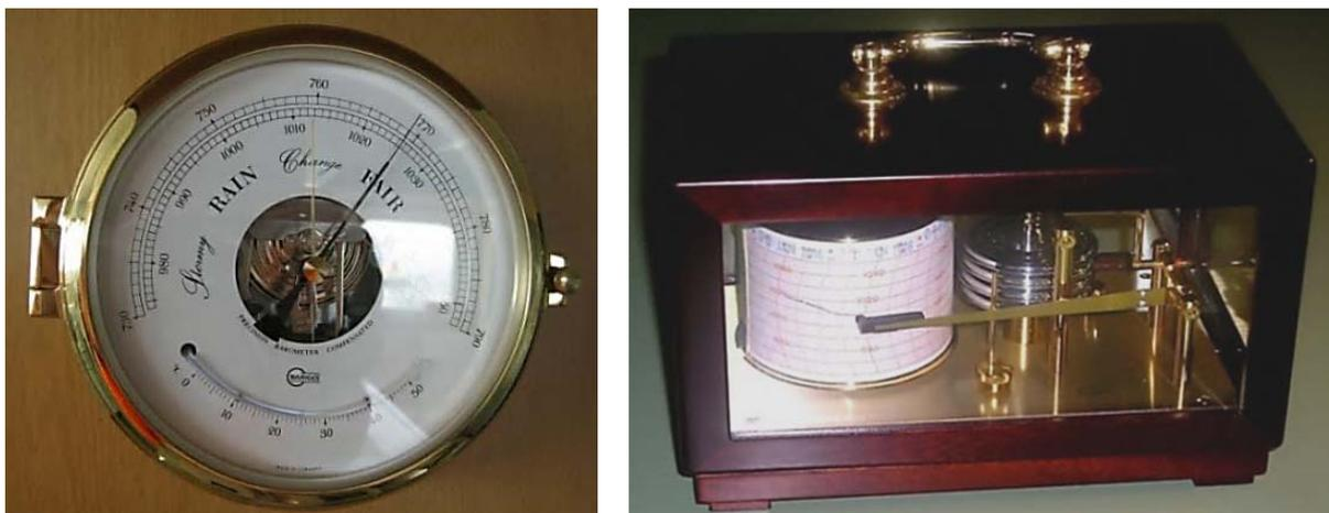
Рис. 16.9. Приборы для измерения атмосферного давления: барометр-анероид и барограф
