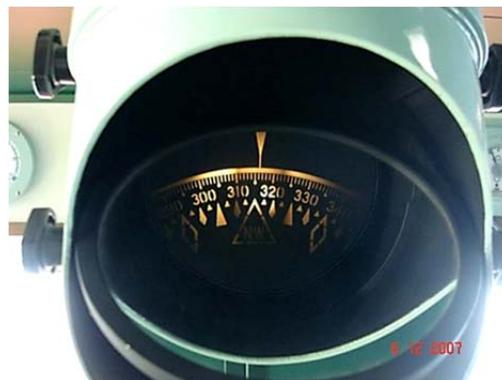
Рис. 17.7. Картушка магнитного компаса, наблюдаемая через оптическую систему
