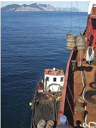
Развал бортов судна в носовой части и кормовой подзор не дают возможности нормально проводить грузовые операции уже при незначительном волнении моря. Швартовные тросы, идущие круто вверх с баржи на палубу судна, испытывают резкие рывки при неустойчивом состоянии плавсредств во время волнения или ветра. Усилия рывков порой достигают таких значений, что происходят повреждение корпуса судна или баржи и обрыв швартовных тросов.
