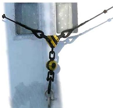
Рис.10.5. Соединение грузовых шкентелей при работе на «телефон»
