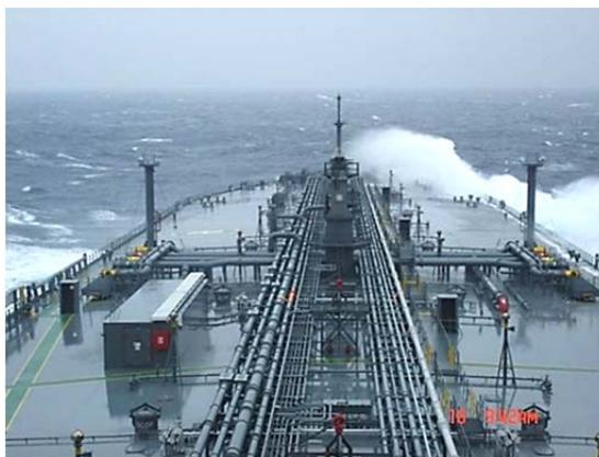
Рис. 4.4. Заливание палубы судна во время шторма
