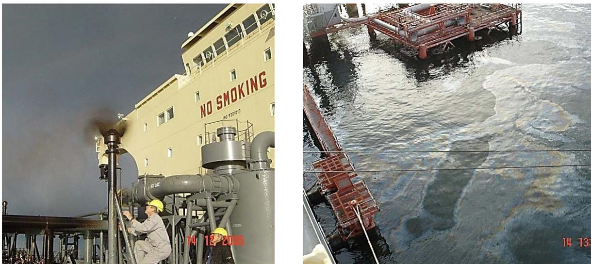
Рис.14.18. Выброс и разлив нефтепродуктов
