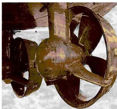
Рис. 1.36. Раздельные поворотные насадки
