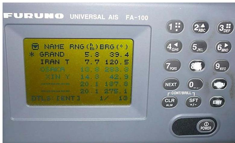
Автоматическая идентификационная система (АИС) обеспечивает автоматический обмен навигационной и иной информацией, связанной с безопасностью мореплавания, между судовыми и другими станциями АИС по специальному каналу радиосвязи. Для передачи и приема информации в АИС используется транспондер УКВ диапа-
