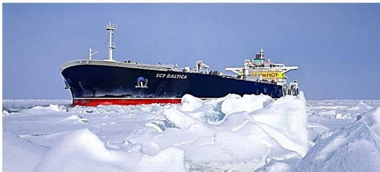
Танкеры, предназначенные для работы в ледовых условиях, строят по комбинированной системе набора.
