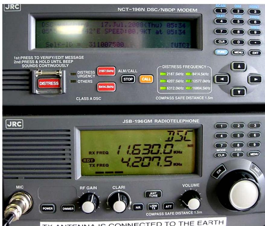
Рис. 13.16. ПВ/КВ радиостанция с ЦИВ контроллером
