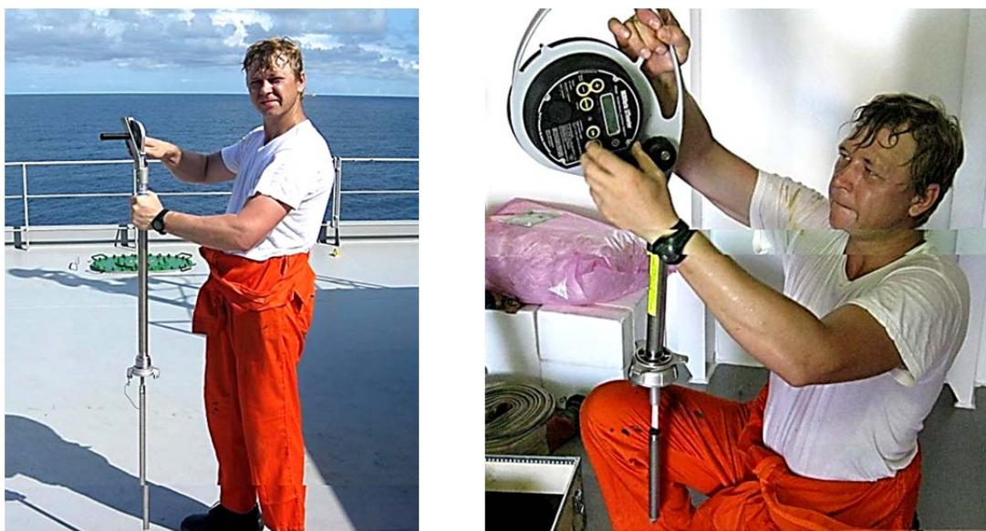
Рис. 11.27. Приборы для определения уровня и качества нефтегруза: футшток и электронный пробник HERMetic UTImeter
