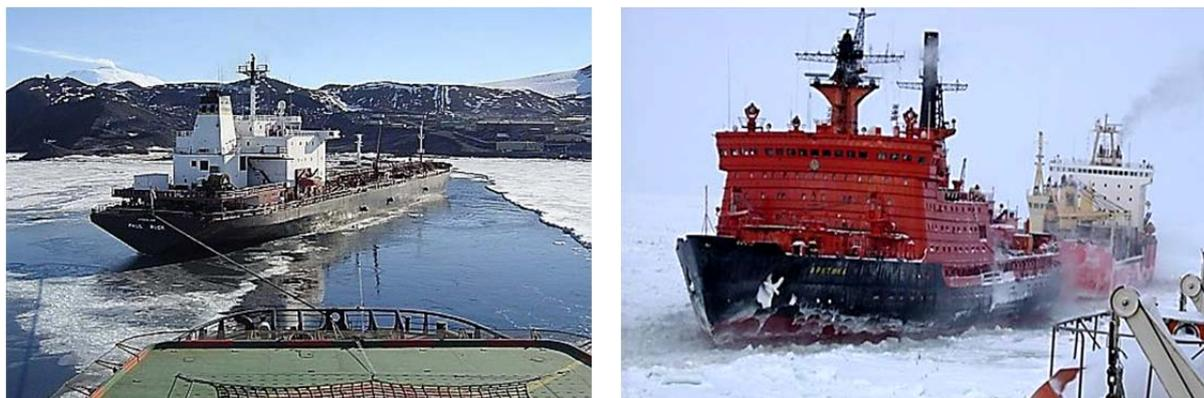
Рис. 6.22. Буксировка транспортного судна
