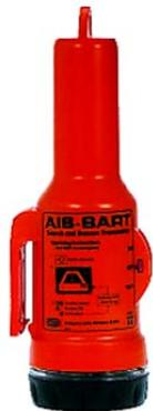
При покидании судна SART устанавливается в шлюпке или плоту в специальном креплении, после чего включается и находится в режиме ожидания. При облучении приемника SART импульсом радиолокационной станции спасательного судна, он начинает излучать ответный сигнал, сигнализируя об этом подачей звукового и светового сигнала.
