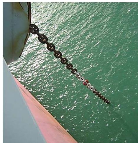
Рис. 2.8. Маркировка якорной цепи
