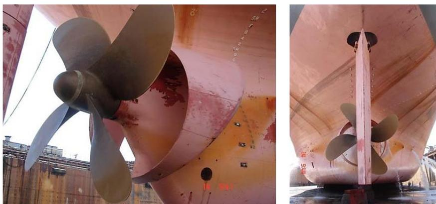
Рис. 1.32. Четырехлопастной гребной винт фиксированного шага
