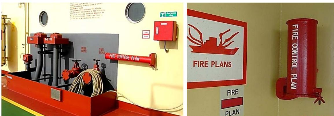
Рис. 14.12. Контейнер со схемами противопожарной защиты судна
