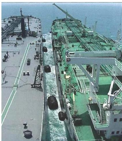
Рис. 3.45. Процесс швартовки двух судов на ходу
