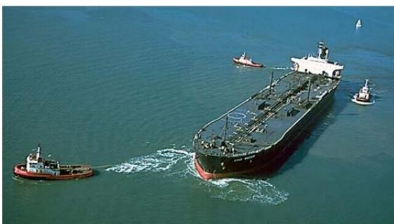
Рис. 3.34. Буксировка судна при помощи буксирных тросов
