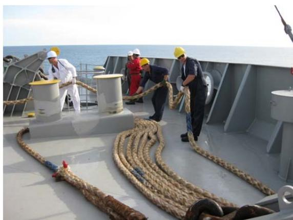
Рис. 3.18. Работа экипажа во время швартовки судна
