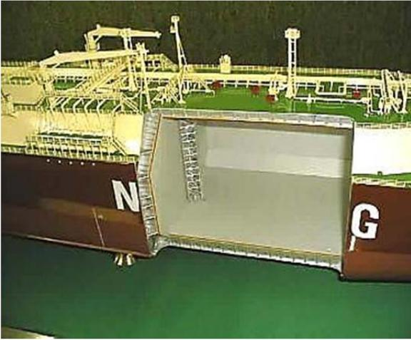
Рис. 11.30. Грузовое помещение танкера-газовоза в виде танка
