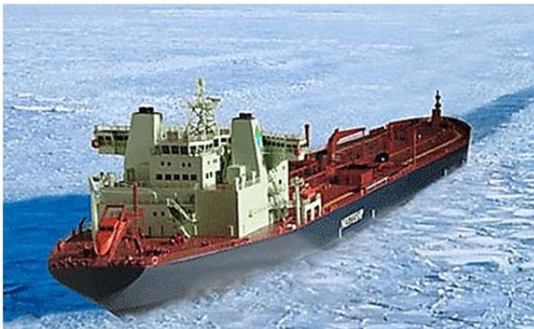
Рис. 1.39. Танкер двойного действия – Double Acting Tanker (DAT) TEMPERA
