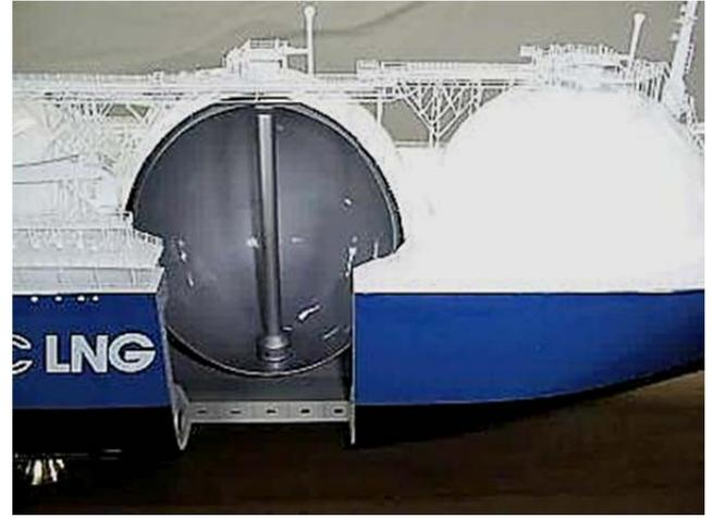
Рис. 11.31. Грузовое помещение танкера-газовоза в виде цистерны
