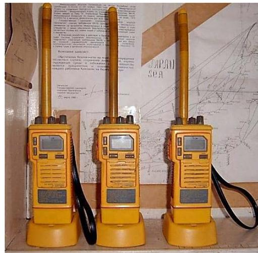
Рис. 12.10. Радиолокационный маяк-ответчик (SART) и переносные УКВ радиостанции
