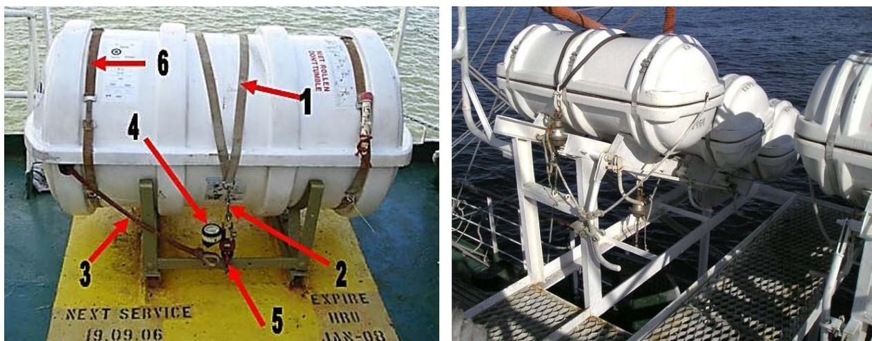
Рис. 12.21. Схема крепления ПСН к судну:
