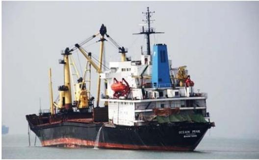
При погрузке или выгрузке груза корпус судна будет подвержен изгибу. *Общей прочностью корпуса судна* называется прочность судна при общем продольном изгибе. При прогибе палуба оказывается сжатой, а днище растянутым, при перегибе – наоборот. На практике расчету подлежит только продольная прочность судна, так как поперечная прочность судна заведомо обеспечена.
