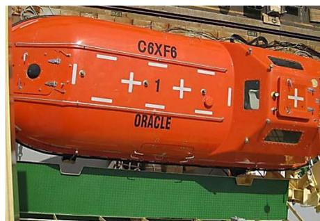
Рис. 12.8. Маркировка спасательной шлюпки
