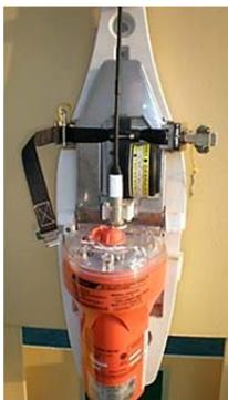
1. АРБ устанавливается на открытой палубе и должен автоматически включаться после свободного всплытия. При погружении на глубину около 4 метров специальное устройство, управляемое гидростатом, освобождает буй.
