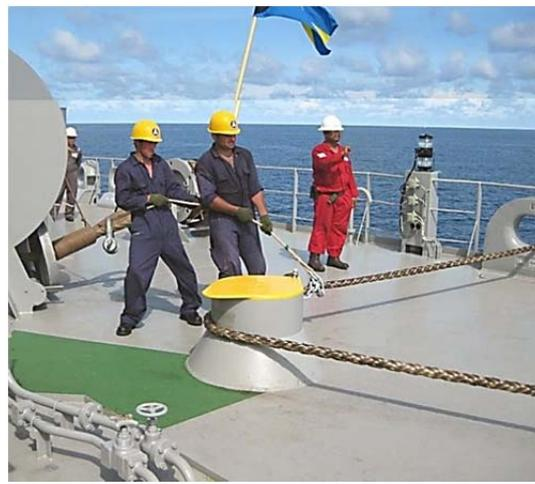
Рис. 3.16. Удержание швартовного троса стопором
