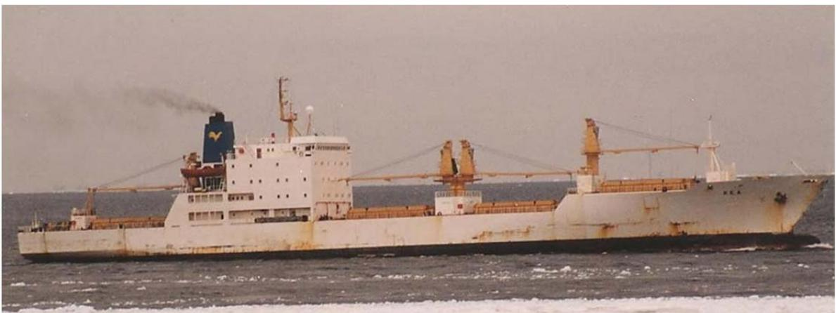
Рис. 1.2 Рефрижераторное судно (Reefer)
