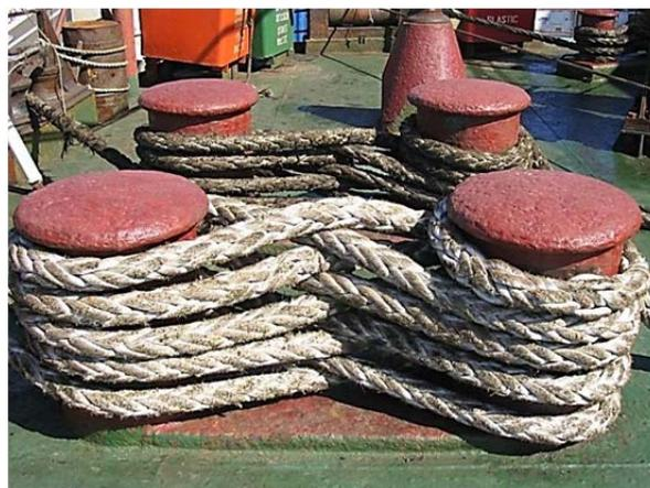
Рис. 3.3. Крепление швартовного троса на кнехте
