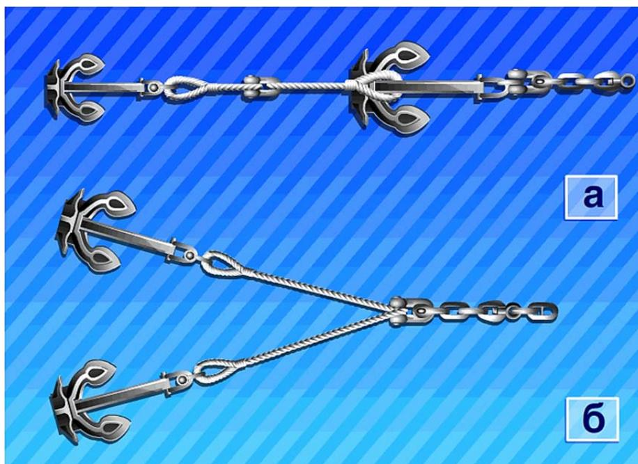
Рис. 7.7. Отдача якорей «гуськом» (а) и «веером» (б)
