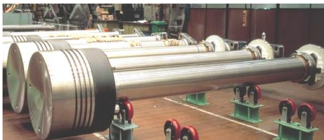
Рис. 4.5. Поршни со штоками дизеля Wartsila RTA96 (фото с сайта http://www.drive2.ru/ )
