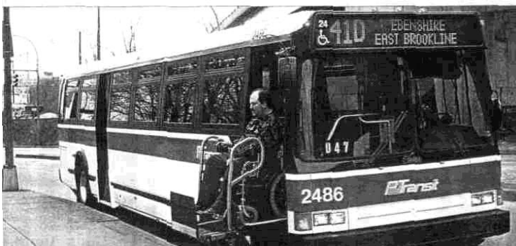
Рисунок 7.11 – Оборудование городского автобуса устройством для посадки и высадки инвалидов
