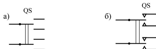
Рис. 8.13. Переключатель двухполюсный 3-позиционный с нейтральным положением (а), с самовозвратом в нейтральное положение (б)
