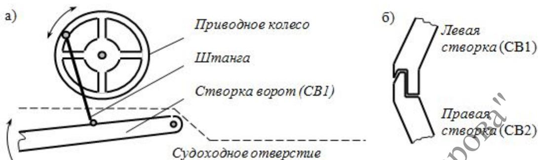
Рис. 1.3. Изобразительные модели кривошипно-штангового механизма (а) и створок ворот в рабочем положении (б)
