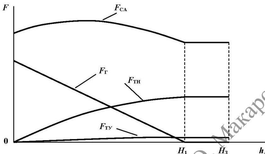
Рис. 3.4. Графики зависимостей нагрузок от высоты подъема ворот в аварийном режиме
